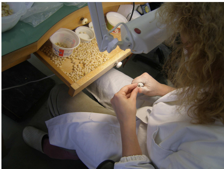
Slika 3: Položaj rok pri brušenju: prevladujeta troprsti pincetni prijem z nedominantno roko in valjasti prijem z iztegnjenim palcem dominantne; zapestji sta večinoma v nevtralnem položaju
